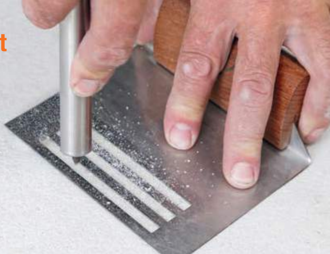
Gutes Ergebnis der Gitternetzprüfung: Gleichmäßig, Tiefe und Breite sind gleich, keine nennenswerten Ausbrüche
