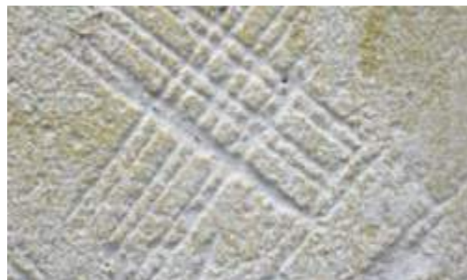
Weicher Untergrund: ■ Erhebliche Ausbrüche ■ Abtrag bis auf feste/tragfähige Schicht ■ Ggf. verfestigende Grundierung/ Ausgleichspachtelung einkalkulieren
