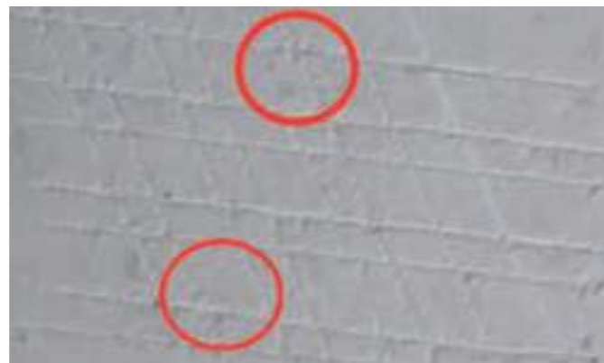
Kein gutes Ergebnis: Ungleichmäßige Ausbrüche in den Kreuzungspunkten
